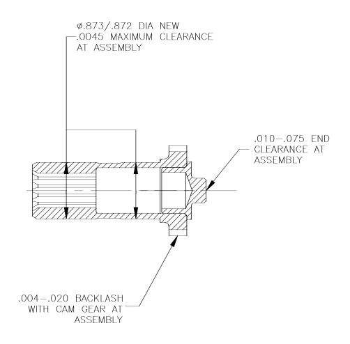
FIGURE 1 VACCUM PUMP GEAR ASSEMBLY
